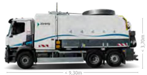
La conception 3 cuves du combiné **ZEPHYR** permet de réaliser différents chantiers sur une même tournée (fosses, réseaux et bacs à graisse).
